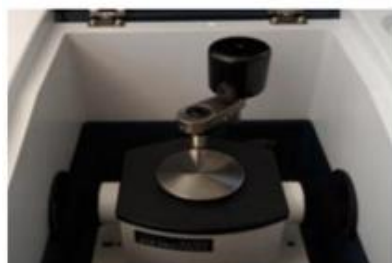
Mô-đun ATR của máy quang phổ FTIR Jasco 4600
