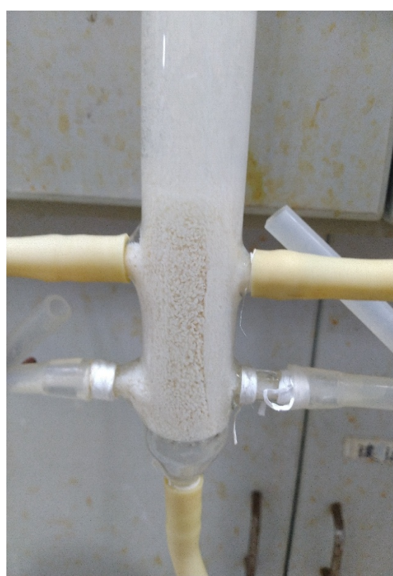
Hình 4.3. Ảnh chạy mô hình thực nghiệm thu hồi Fe và Al trong bùn đỏ
